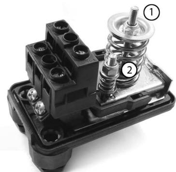
включения прежним (1,4 бар), поступайте следующим образом: вращением гайки 2 по часовой стрелке, поднимите давление отключения насоса до требуемой величины, при этом на такую же величину увеличится давление включения насоса. Далее, вращением гайки 1 по часовой стрелке добиваемся того, что давление включения насоса вновь становится равным 1,4 бара.
